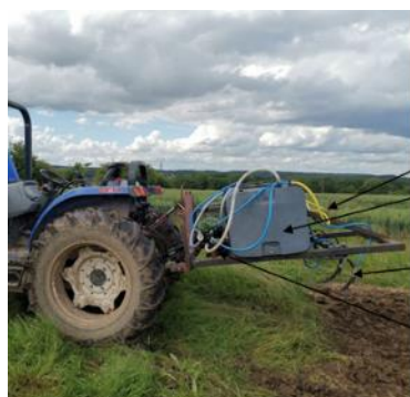
Structure métallique Cuve de 400L Dent de vibroculteur avec tuyau pour injecter l'urine Pompe de pulvérisateur
