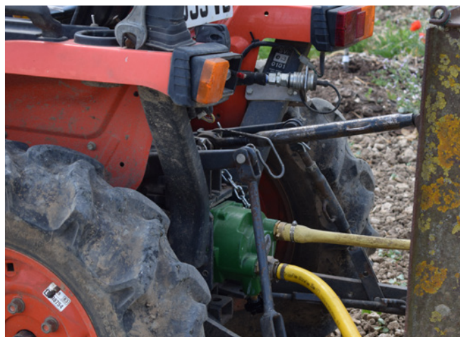
Motopompe reliée à la prise de force du tracteur (modèle Ferroni MLI. 25)
