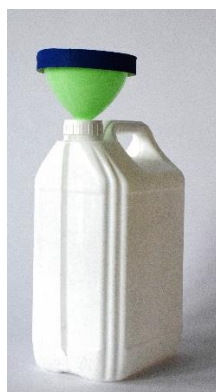
Figure 30 : Bidon 5L et entonnoir inséré dans le bouchon avec couvercle boîte camembert.
