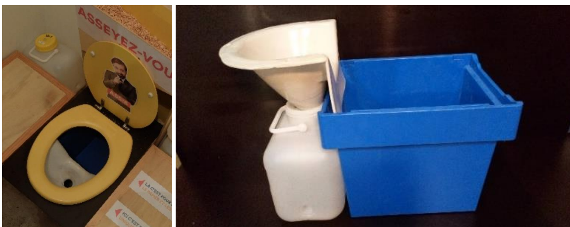
Figure 14: Toilettes sèches à séparation « Bibok » développées par Un Petit Coin de Paradis. A droite, système intérieur de la toilette : séparateur en céramique, bidon de 10 litres en dessous pour l'urine, caisse en plastique refermable pour les fèces, les copeaux et le papier toilette (matériel disponible sur https://www.bibok.fr/ ) Crédit : La Fumainerie.
