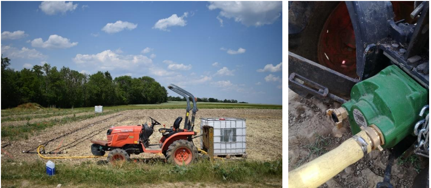
Figure 90 : A gauche : fertilisation d'une bande de Miscanthus par goutte-à-goutte (lisain dilué à 15% appliqué à 20L/m 2 ), en utilisant la motopompe. A droite : motopompe reliée à la prise de force du tracteur.
