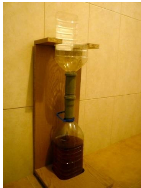
Figure 22 : A gauche, bidon découpé pour faire un entonnoir utilisable par les femmes (à porter à la main et approcher de sa vulve). Source : Chris Canada ( https://inodoroseco.blogspot.com/ ). A droite : Deux bouteilles en plastique de 5L assemblées par des éléments en PVC et support en bois pour maintenir le système en place. Source : Susana Forum ( https://forum.susana.org/172-urinals/6679-simple-urine-valves-to-control-odour-on-waterless-urinals-or-on-urine-diversion-toilets?start=12 )
