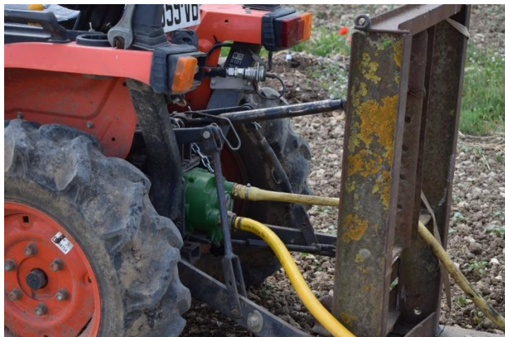
Figure 84 : Motopompe reliée à la prise de force du tracteur (modèle Ferroni M.L.I. 25)
