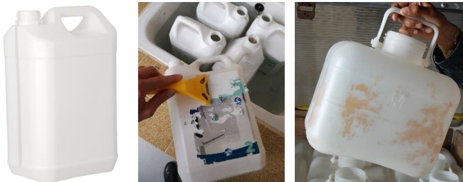
Figure 10: A gauche, bidon 5L avec ligne transparente pour contrôle visuel du niveau. Au milieu, nettoyage des bidons et décollage de l'étiquette. A droite, dépôts sur les parois d'un bidon d'urine translucide.
