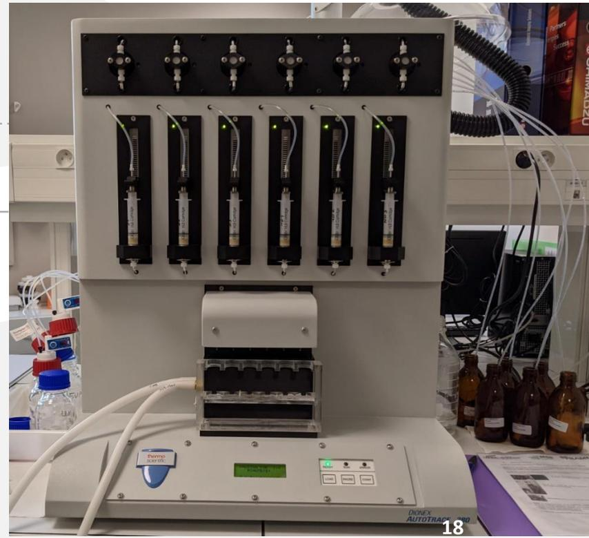
***Appareil de purification pour une SPE***
