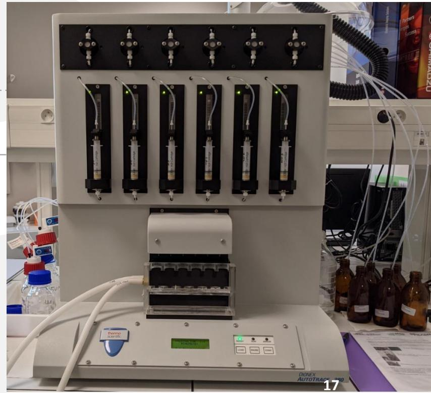
***Appareil de purification pour une SPE***
