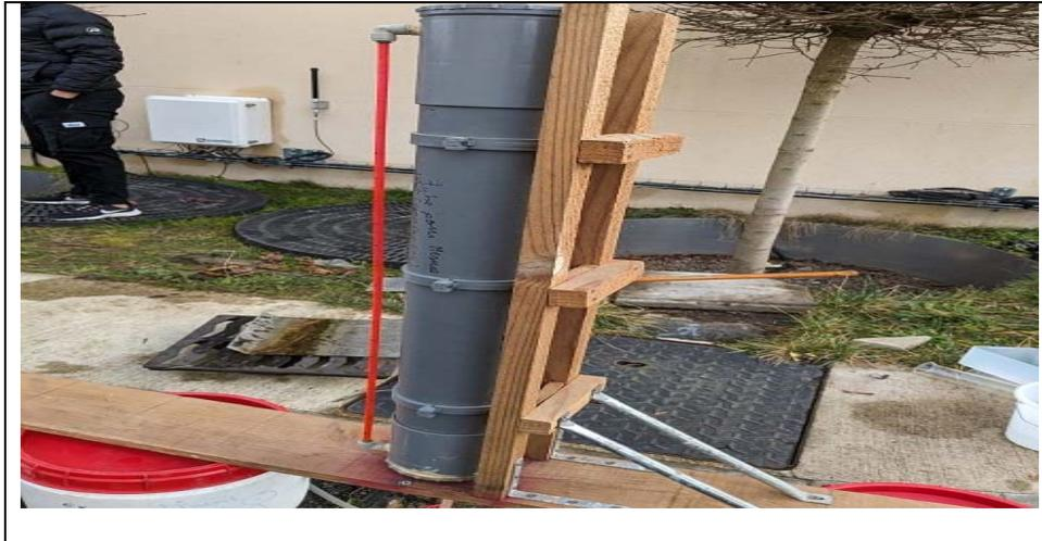
Dispositif d'injection du traceur (sel)
