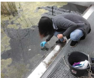
Les échantillons sont pris 10 cm sous la surface de l'eau directement avec une main gantée dans un flacon de prélèvement ou à l'aide d'un seau à 1 mètre du bord. Les récipients de prélèvements (flacon PEHD 1litre pour analyse chimiques/ flacon en verre stérile pour les analyses microbio) sont rincés 3 fois avec l'échantillon avant la prise définitive. Le récipient est marqué (nom du point et la date d'échantillonnage) et transporté au laboratoire.
