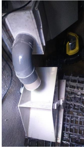
Figure 15 : Bac en téflon de récupération et de prélèvements des eaux drainées et augets basculants de 4 L
