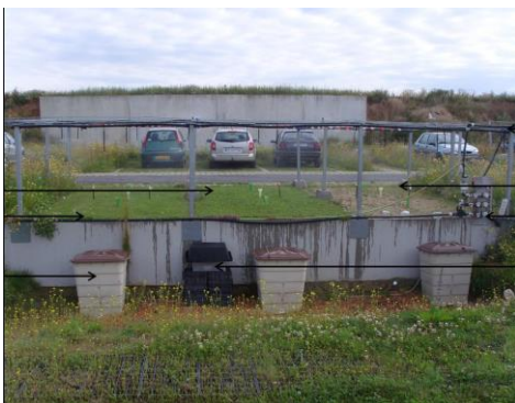
Figure 10 : Récupérateurs d'eau placés au pied des places lysimétriques et abritant les débitmètres à augets basculants (à droite) (Broué 2014, Rollin)
