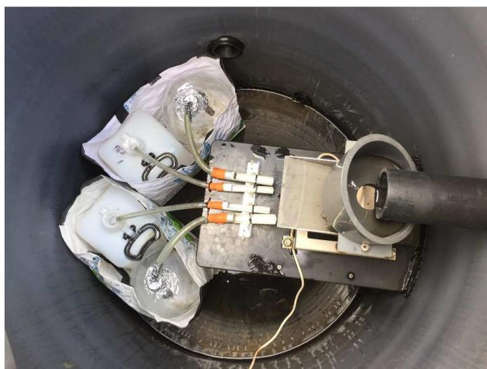
Figure 43: Système de fractionnement de l'eau dans la cuve de l'accotement filtrant
