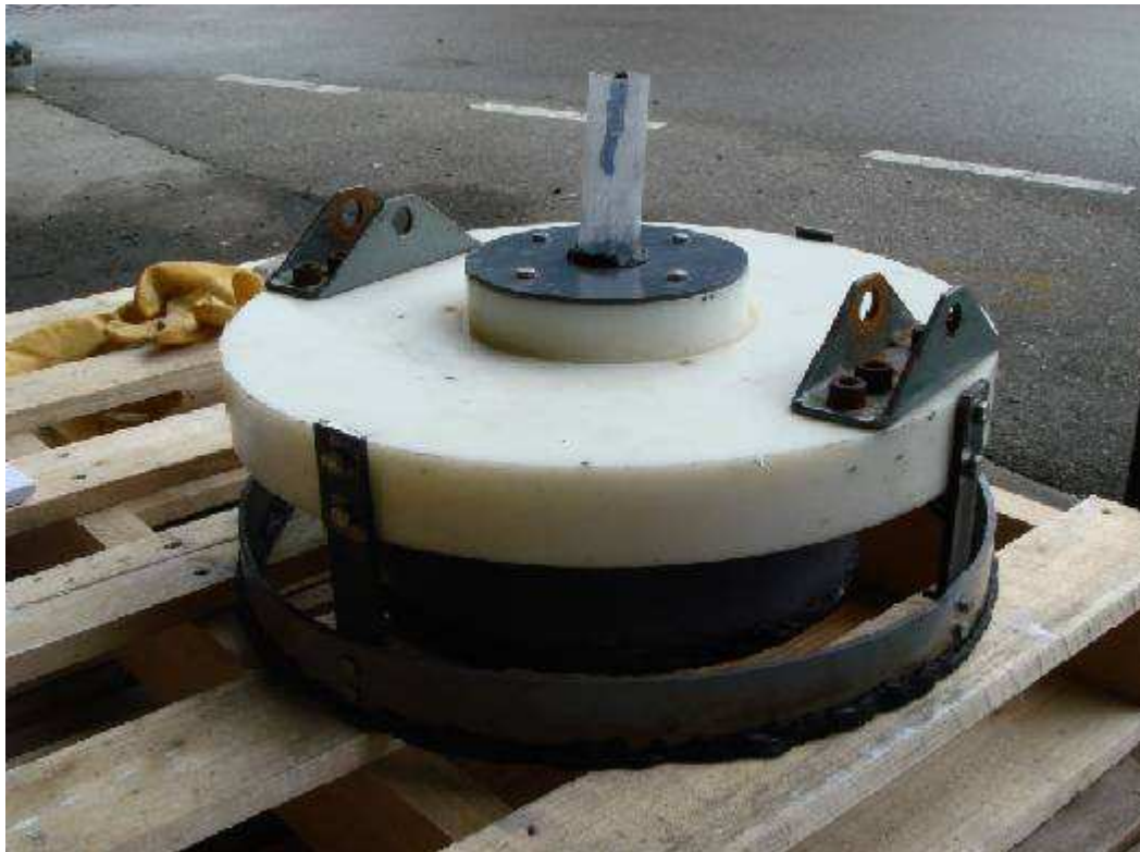
Figure 26 : Prototype d'infiltromètre pour chaussée définitif
