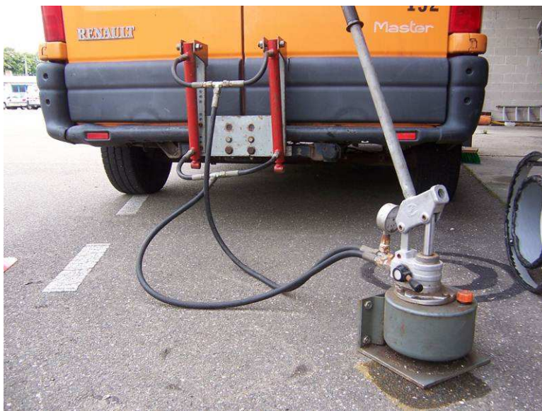
Figure 23 : Les vérins hydrauliques et la pompe à main
