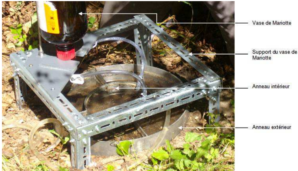
Figure 9 : Infiltromètre à double anneau à charge constante
