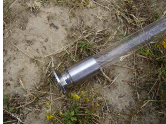
Figure 30 : Boucle de serrage : tube de mesure
