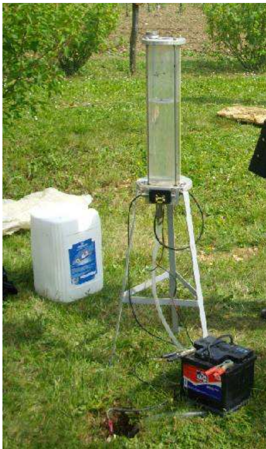
Figure 11: Le Porchet à charge constante du CETE de Trappes
