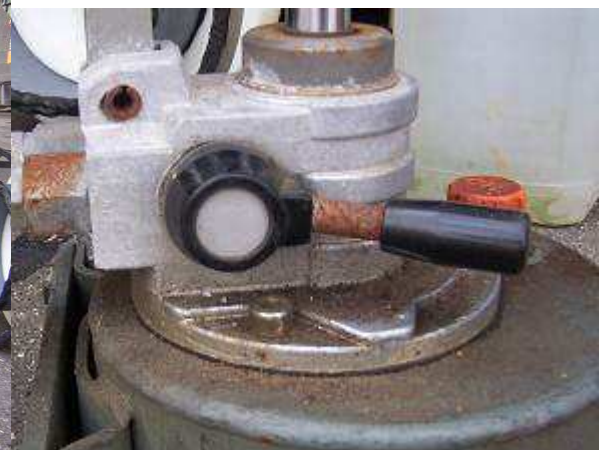
Figure 22 : Commutateur de la pompe hydraulique
