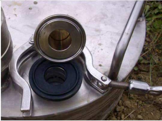
Figure 29 : Boucle de serrage : base
